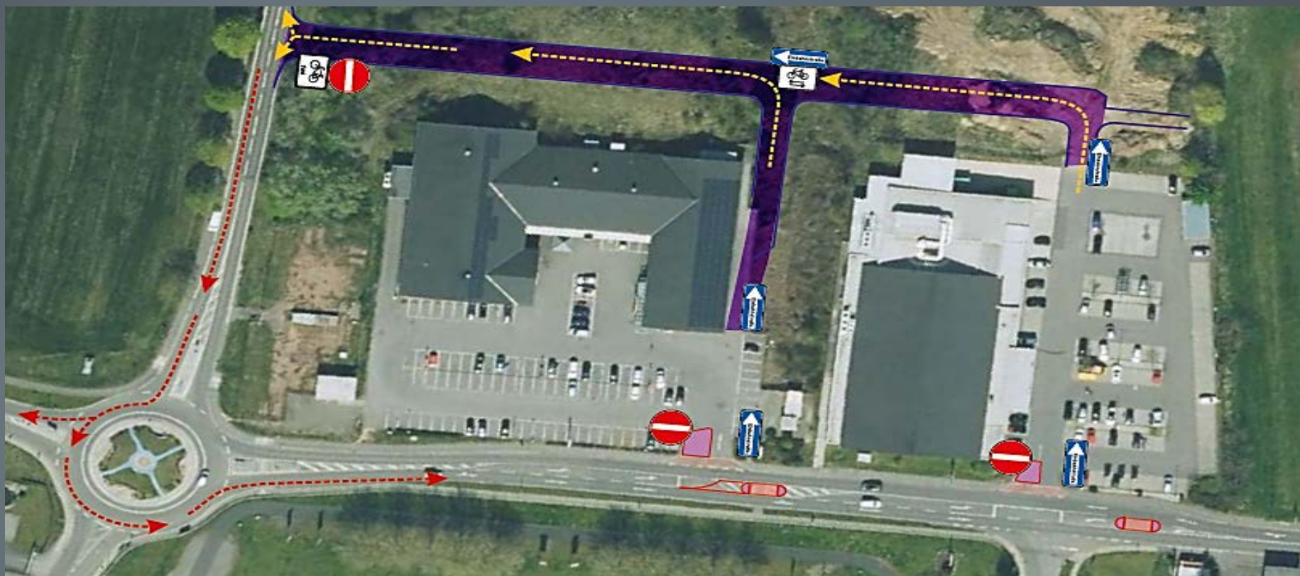
Sichere Führung der Ein- und Abbiegeströme durch Neubau einer rückseitigen Ausfahrt zur L 106 (kombinierbar mit einer neuen Radführung)
